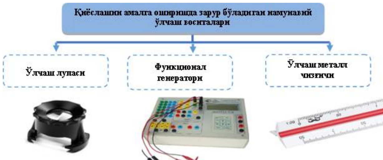
Расм 4. Қиёслашни амалга оширишда зарур бўладиган намунавий ўлчаш воситалари
