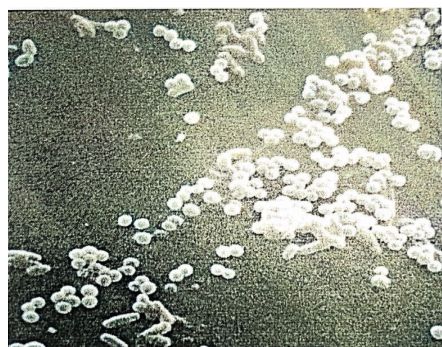
Рис. 8. Микроорганизмы на поверхности волокон сетки после лазерного воздействия. СЭМ x2000.
