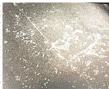
Рис. 7. Микроорганизмы на поверхности волокон сетки. СЭМ x2000.
