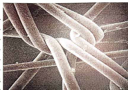
Рис. 6. Нативная проленовая сетка. СЭМ x10.
