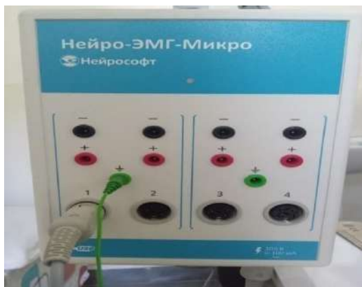
Расм 1. 4-каналли ЭНМГ ва ЮЧ "Нейро-ЭМГ-Микро (Россия) русумидаги рақамли тизимга эга аппарат.
